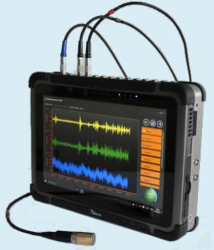
Die Analyse der Daten kann direkt vor Ort am PeakStore5 erfolgen oder später am heimischen PC. Es ist auch eine FTP-Schnittstelle vorgesehen, um die Daten unmittelbar nach der Messung zu einer Überwachungsstelle zu übertragen, wo gleich im Anschluss an die Messung die Analyse erfolgen kann. In der Software PeakAnalyzer Manager stehen komplexe Analysewerkzeuge zur Verfügung, die eine weitgehend automatisierte Beurteilung der Schwingungsdaten ermöglichen.
