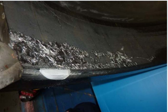
Schaden am Hauptlager einer WEA, Foto: Martin Veltrup
