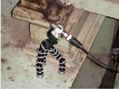
optischer Drehzahlsensor für Offline-Messungen mit magnetischem Stativ – Optical speed sensor with magnetic stand
