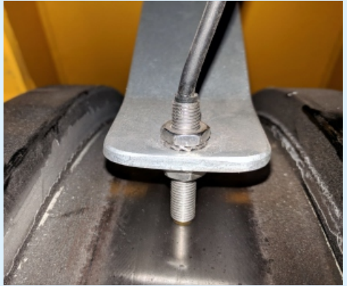
Wegsensor am Rad eines Kranfahrwerks - Displacement sensor at the wheel of a crane running gear
