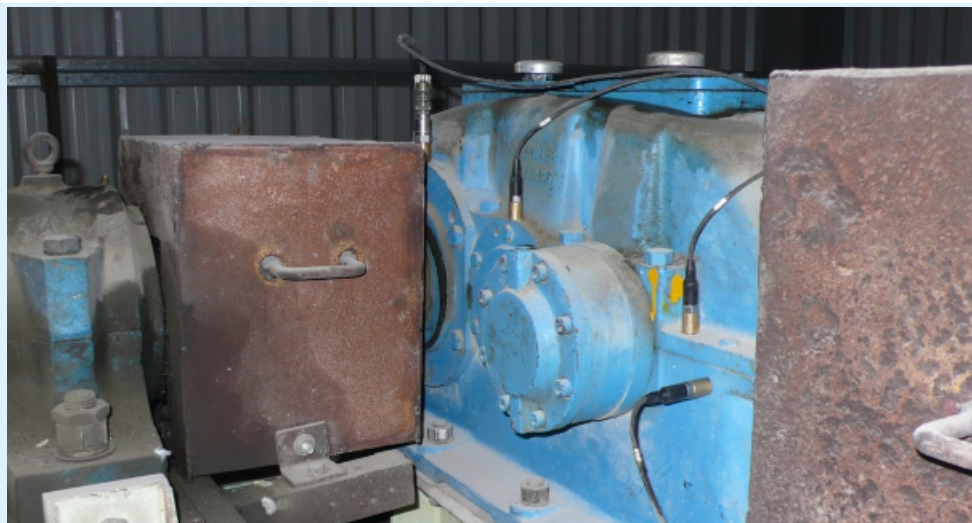
Beschleunigungssensoren am Getriebe mit Magnetankopplung – Acceleration sensor at gear box with magnetic coupling
