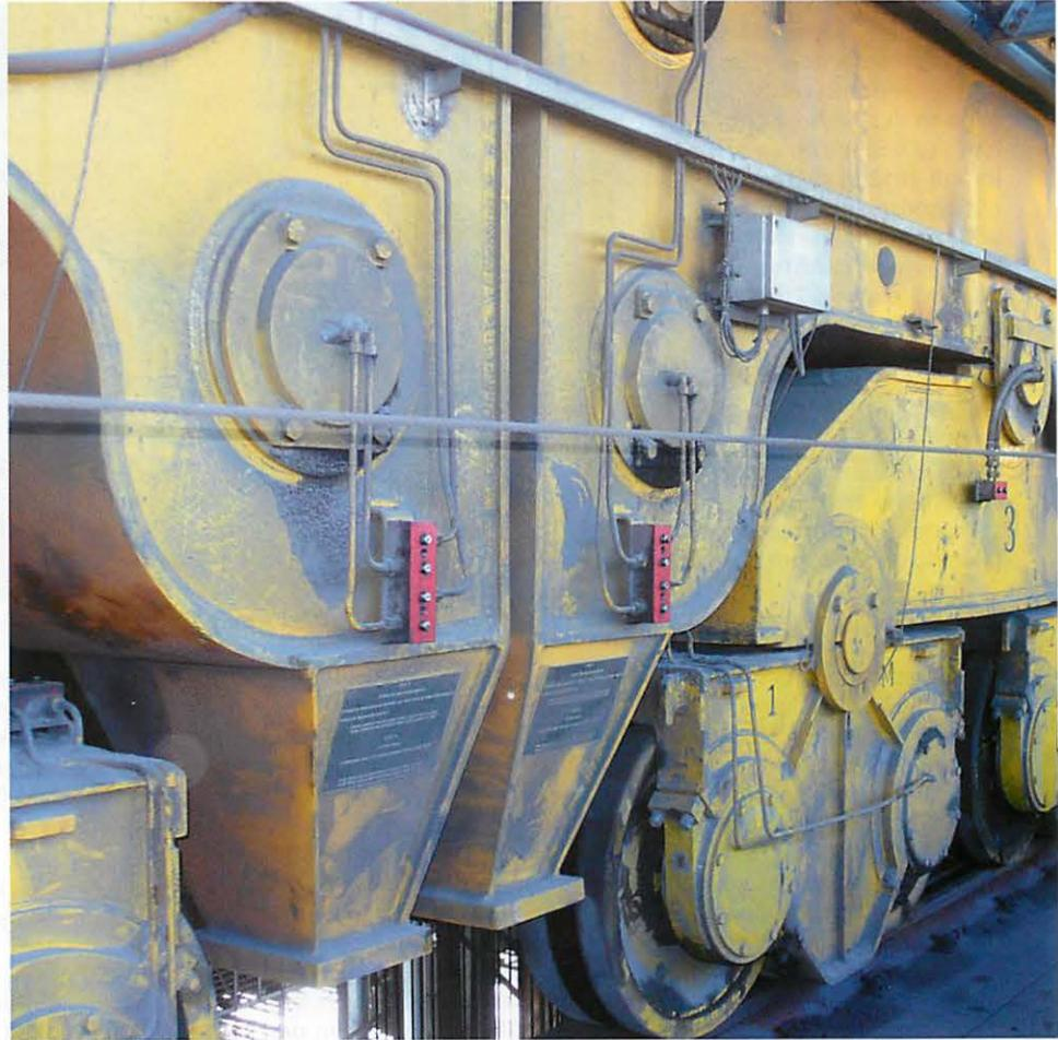
1 Durch Condition Monitoring überwacht Fahrwerk eines Krans in einem Stahlwerk
