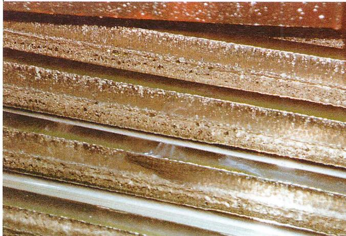
2: Umlaufende Verzahnungsschäden an einer Zahnflanke
