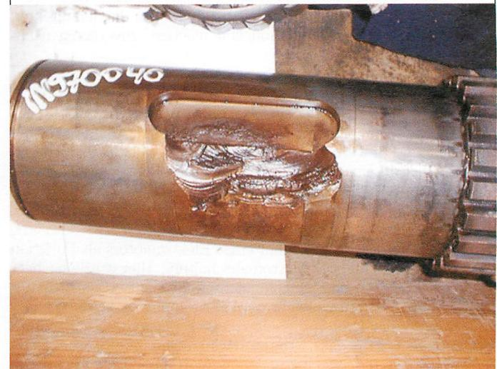
7: Wellenschaden an einer Passfedernut
