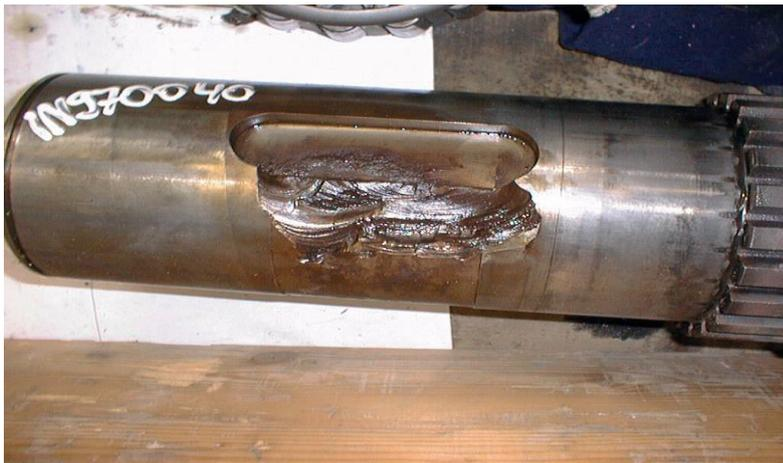
Bild 5: Ausbruch im Bereich der Passfeder an einer Welle [2]
