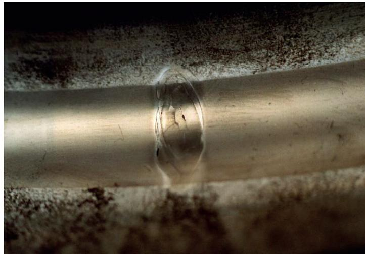
Bild 7: Ermüdungsschaden am Außenring eines Wälzlagers
